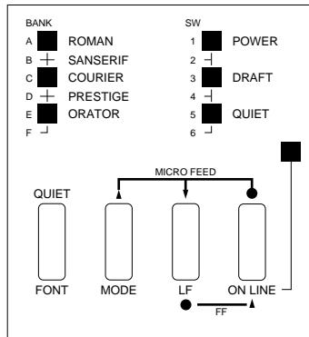
В этой главе описаны основные функции, которые можно выполнить с помощью кнопок панели управления при включенном принтере когда он находится в состояниях on-line и off-line. Кнопки имеют другие функции в режимах EDS и регулировки точек. Функции кнопок панели управления в этих режимах описаны в соответствующих разделах инструкции.
